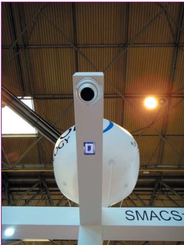
Рис. 4. Antitailgating система на основе видеокамеры
