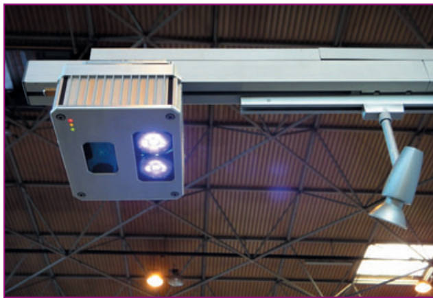
Рис. 5. Antitailgating система на основе инфракрасных датчиков
